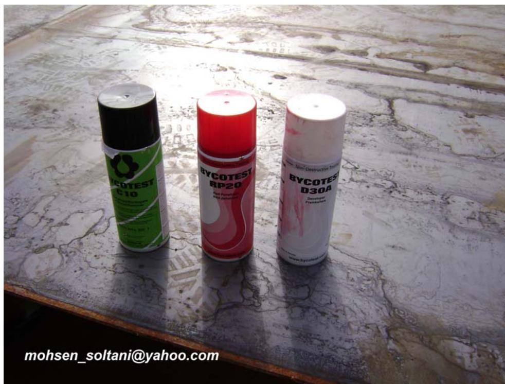
شکل ۲۶_ مواد مورد استفاده در تست PT
