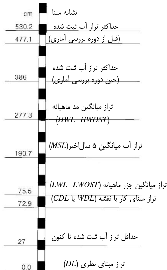
شکل ۲-۷۴- نمونه‌ای از نمای تراز آب برای یک ایستگاه اندازه‌گیری کسند
