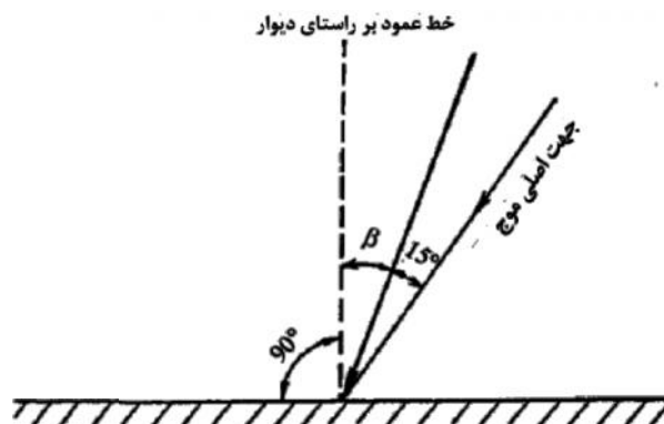
شکل ۲-۶۲- روش به‌دست آوردن زاویه موج تابشی S
